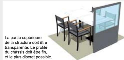
La partie supérieure de la structure doit être transparente. Le profilé du châssis doit être fin, et le plus discret possible.
