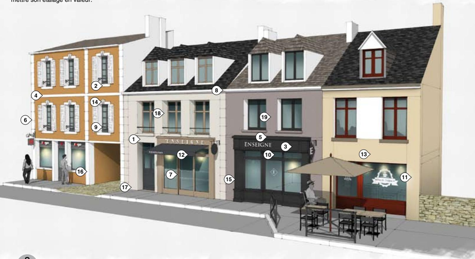
**1. Allège** : élément plein situé sous une baie, entre l'appui et le plancher.
