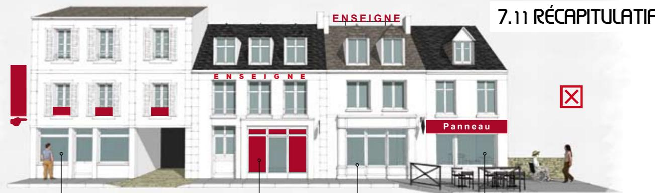
Les enseignes sont positionnées sur un élément d'architecture (les garde-corps) et ne sont pas fixées dans le cadre de la devanture. L'enseigne en drapeau n'est pas à l'échelle du bâtiment.
